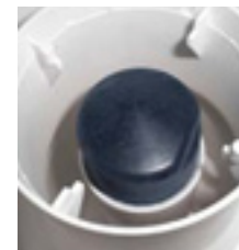
Нагревательный элемент с покрытием, аналогичным тефлоновому
